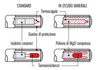
Caratteristice delle sonde con isolamento in MgO Utilizzano cavi ad isolamento minerale che sono costituiti da conduttori inseriti in una guaina metallica continua non saldata, isolati fra loro e della guaina stessa con isolante minerale (ossido di magnesio purissimo) molto compresso. Questa tecnica di frabbricazione garantisce la stabilità nel tempo delle caratteristiche nelle più avverse condizioni di corrosione e temperatura.
