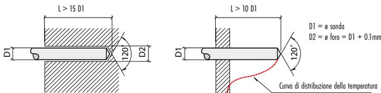
**Raccomandazioni per il montaggio di una sonda tipica**
